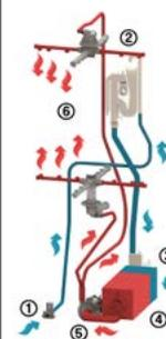
El proceso de lavado se efectúa mediante la bomba incorporada en la máquina y el agua de la cuba. En el proceso de aclarado de la máquina, temperatura y presión permanecen CONSTANTES durante todo el ciclo.
