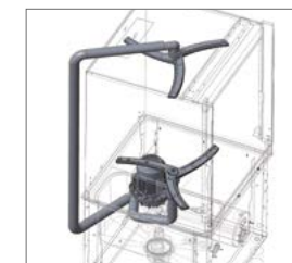
Bomba de doble flujo.
