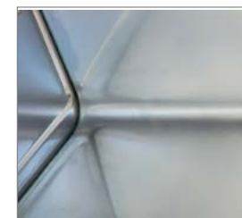
Cantos internos redondeados para facilitar limpieza
