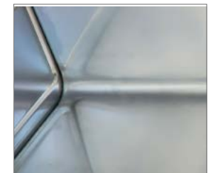
Cantos internos redondeados para facilitar limpieza
